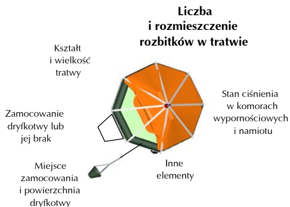
Rys. 1. Parametry techniczno-eksploatacyjne powodujące zakłócenia w kierunku i prędkości znosu wiatrowego [2]
