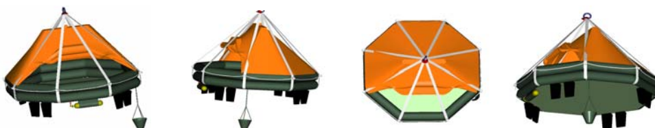
Rys. 2. Widok tratwy ratunkowej z namiotem, dryfkotwą i systemem balastowym [2, 3]
