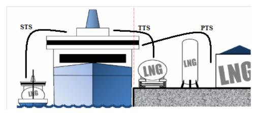
*Fig. 3. Possibility of LNG bunkering: STS, TTS, PTS [LNG in Baltic Sea Ports]* **Rys. 3.** Możliwości bunkrowania LNG: statek/statek, cysterna/statek, terminal/statek
