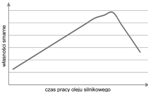
Rys. 3. Zależność własności smarności w funkcji czasu pracy oleju
