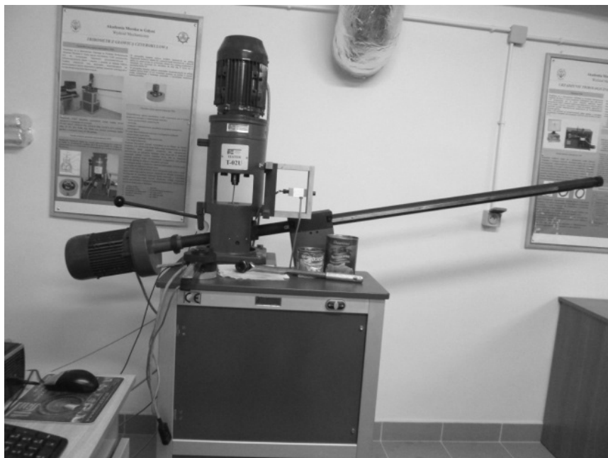
Rys. 2. Tribometr z głowicą czterokulową T-02U
