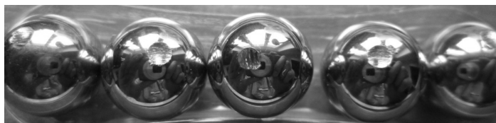
Rys. 2. Ślady zużycia na kulkach
