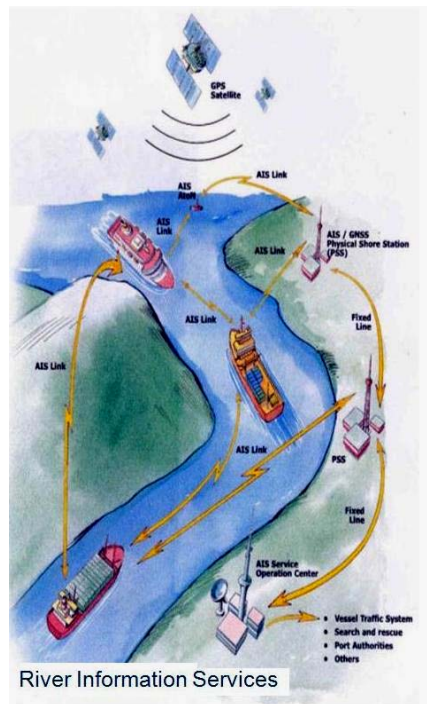
Rys. 2. Schemat funkcjonowania Rzecznego Serwisu Informacyjnego RIS ( River Information Service )
