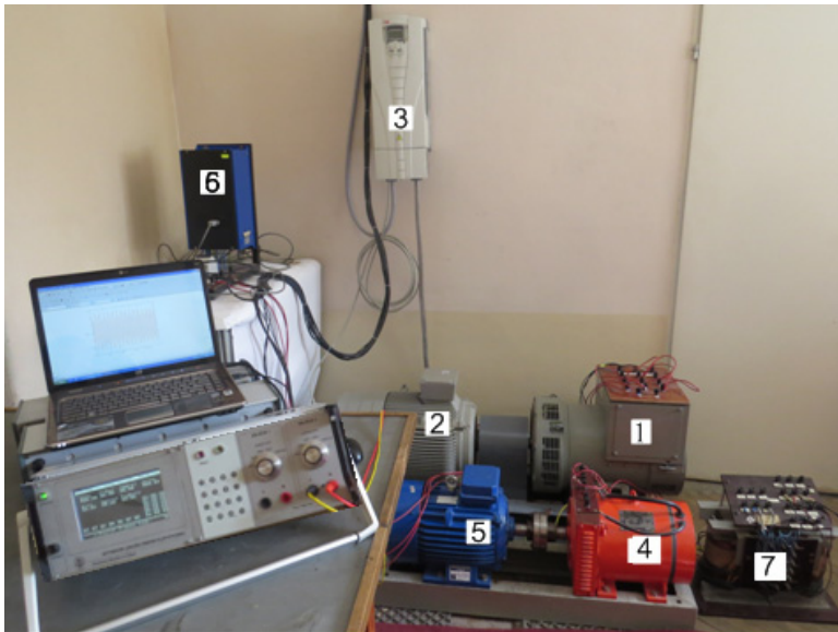
Rys. 5. Zdjęcie układu wielomaszynowego do generowania subharmonicznych i interharmonicznych [15]
