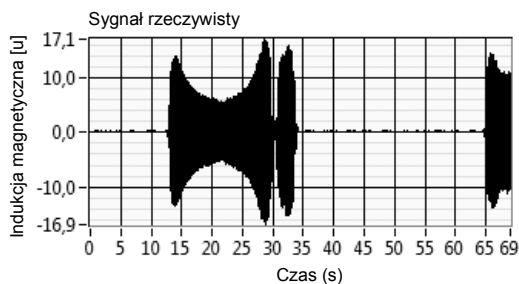
Rys. 3. Przebieg czasowy indukcji pola magnetycznego, zarejestrowany na statku morskim w trakcie manewrów [11]
