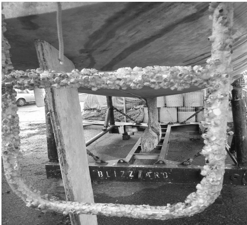
Rys. 4. Drabinka z widocznymi skorupiakami
