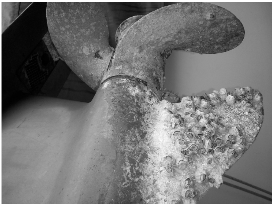
Rys. 2. Skorupiaki widoczne przy śrubie
