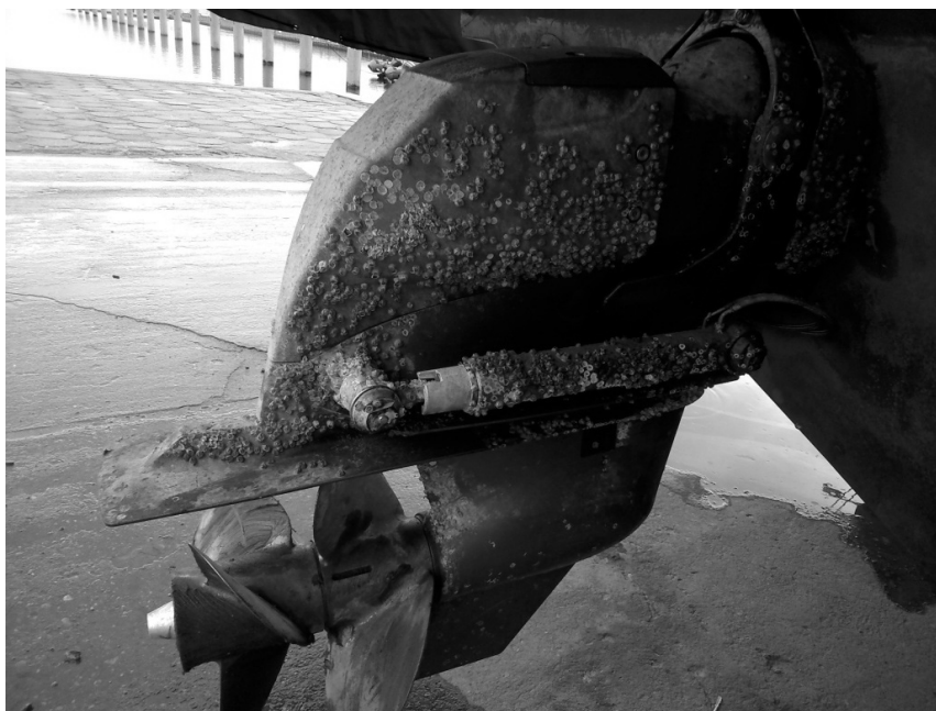
Rys. 1. Porośnięta płetwa sterowa na jachcie
