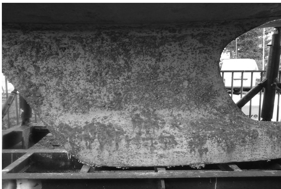
Rys. 3. Porośnięty stalowy kil jachtu
