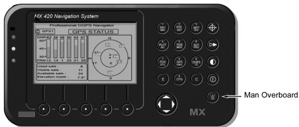
Rys. 5. Panel czołowy odbiornika GPS MX 420 [1]
