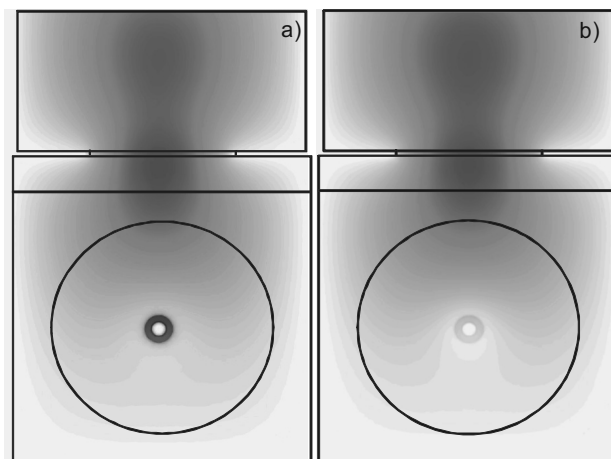
Rys. 10. Wpływ względnej przenikalności elektrycznej wkładki dielektrycznej \varepsilon oraz odległości elektrod w na częstotliwości rezonansowe wybranych modów rezonatora przedstawionego na rysunku 8 dla s = 25 i dla dwóch wartości unormowanej koncentracji elektronów n w plazmie: a) n = 20 ; b) n = 100
