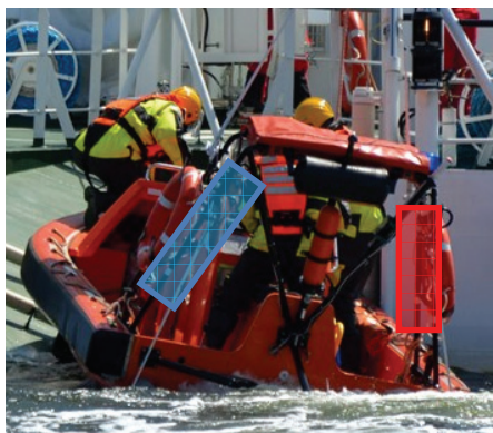
Rys. 9. Propozycja rozmieszczenia składanych noszy i kosza na łodzi ratowniczej R3 (widok z rufy)
